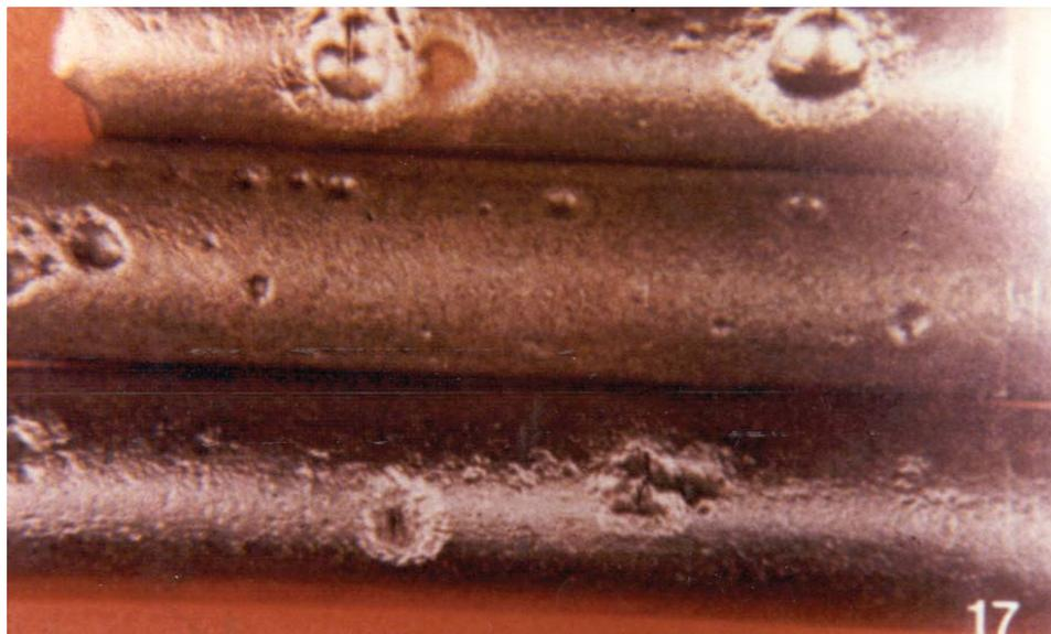
**Figura 2.3 Corrosión por picadura debido al  $H_2S$  <sup>[17]</sup>**
