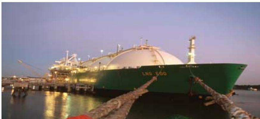
**Figura 3.12: Buque con tanque de almacenamiento esférico.**
