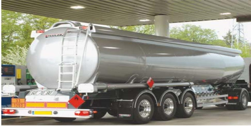
**Figura 3.10 Transporte GNL a través de camiones cisternas.**
