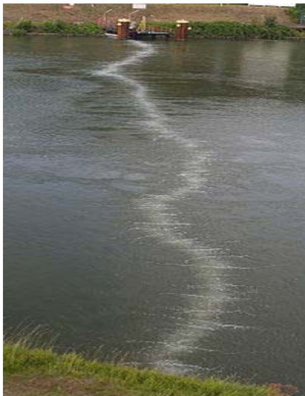
Figura 3.20 Estela de burbujas en la superficie del agua de un lago expulsadas de una barrera neumática sumergida. [39].
