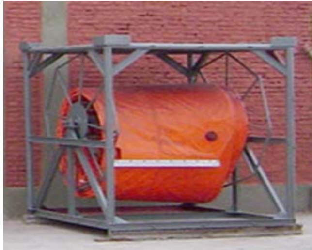
Figura 3.18 Barrera mecánica desinflada y recogida [37].
