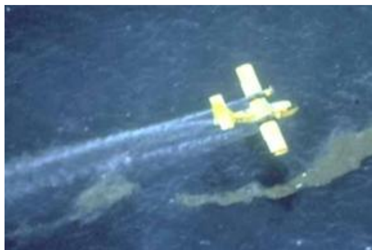
Figura 3.33 Dispersante aplicado desde una aeronave [47].
