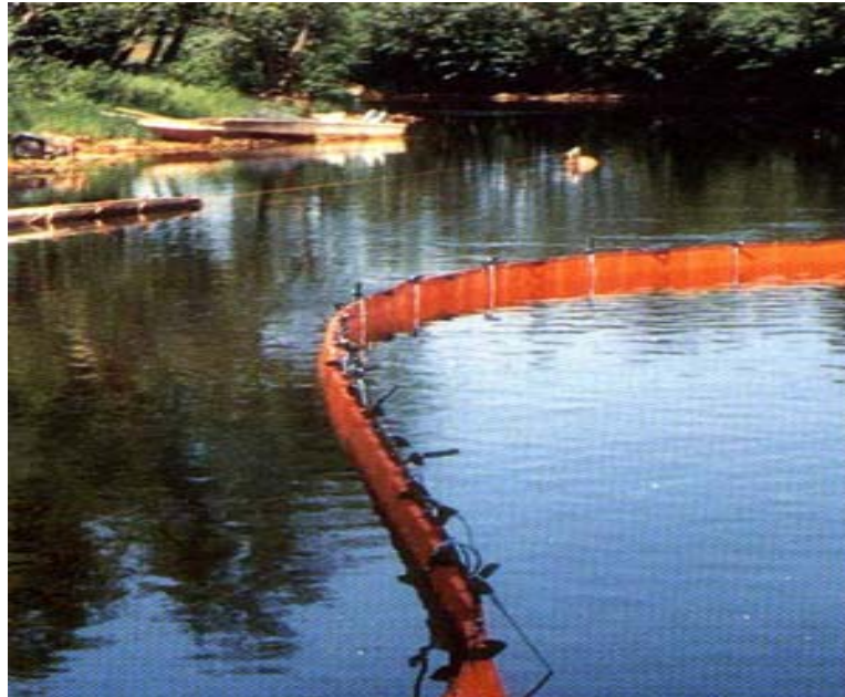
Figura 3.16 Barrera mecánica tipo valla [35].
