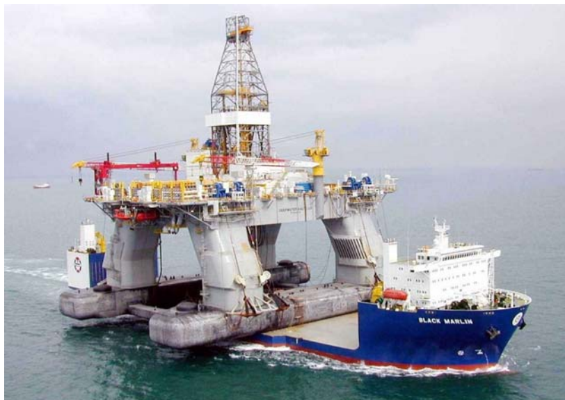
Figura 3.1 Plataforma Deepwater Horizon transportada al lugar de exploración [23].
