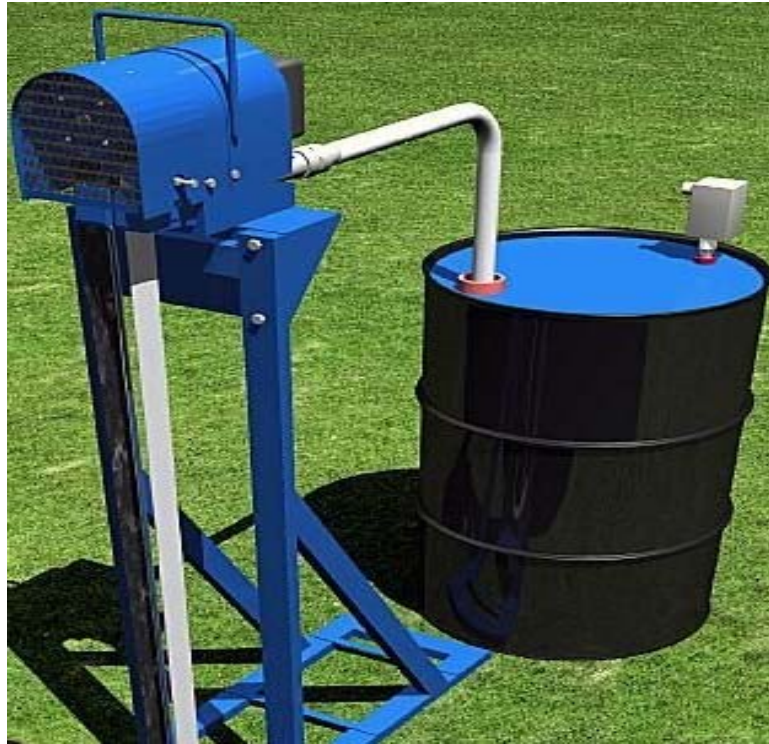
Figura 3.26 Recuperador (Skimmer) de Correa Oleofílica [43].
