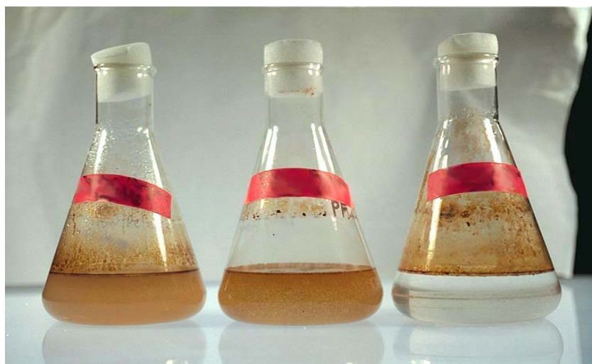
Figura 3.34 Ensayo de laboratorio con agentes biológicos para biorremediación en derrames de petróleo [48].
