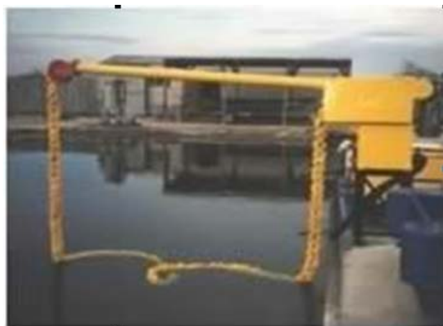
Figura 3.25 Recuperador (Skimmer) de Cuerda Oleofílica [42].
