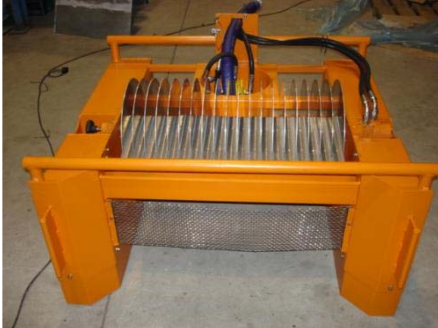
Figura 3.24 Recuperador (Skimmer) de discos Oleofílicos [41].
