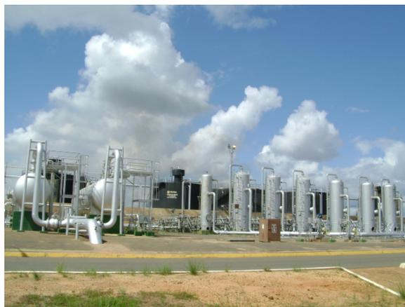
**Figura 2.8.** Separadores horizontales y verticales de la estación de descarga BARED-
