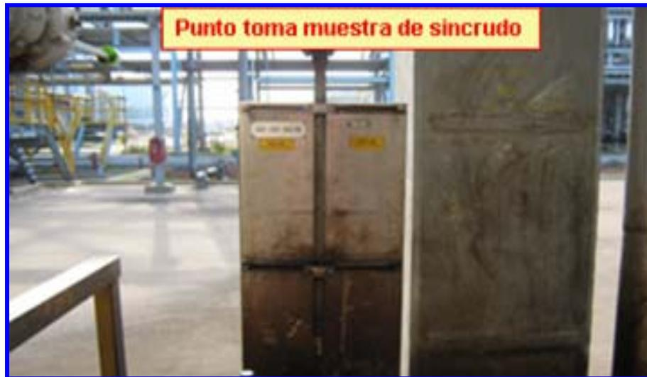
**Figura 3.8** Toma muestra de sincrudo, dispuesto para muestras líquidas.
