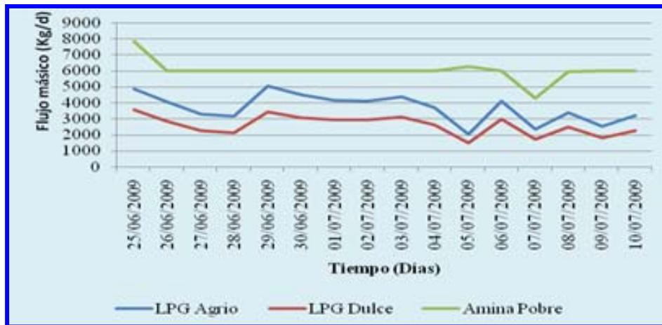
**Figura 4.2** Flujos promedio de las corrientes de LPG y amina (antes durante y después de las pruebas realizadas con secuestrante de H<sub>2</sub>S).
