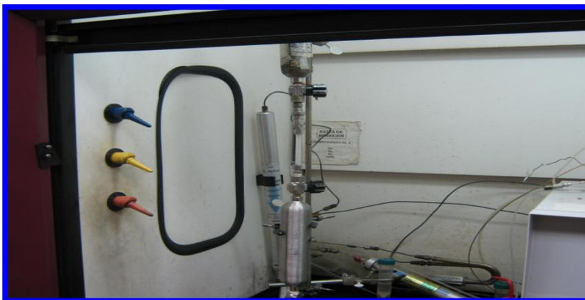
**Figura 3.11** Montaje del cilindro presurizado para conexión al cromatógrafo.
