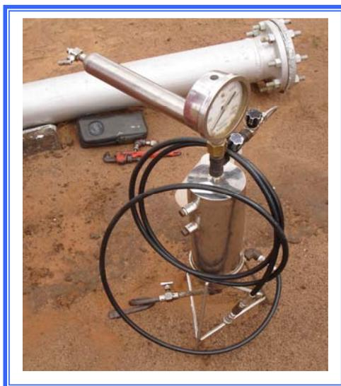
**Figura 3.5** Cilindro con filtro incorporado.
