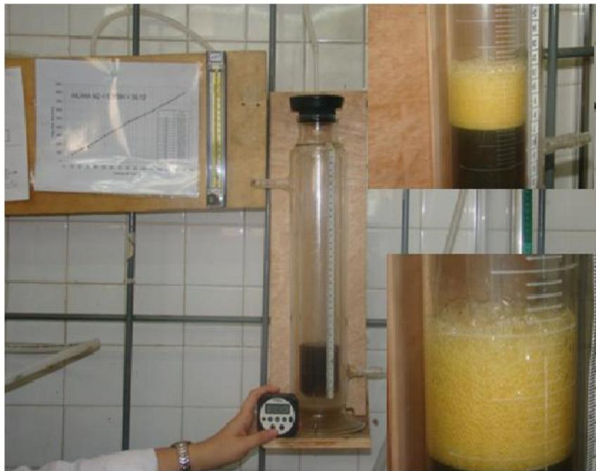
Figura 4. 1 Equipo ASTM-D 892 modificado, utilizado para medir Espumabilidad y estabilidad de espumas no acuosas.
