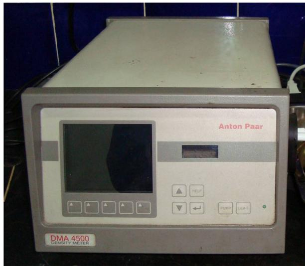
**FIGURA A.4.** *Densímetro digital DMA-4500.*
