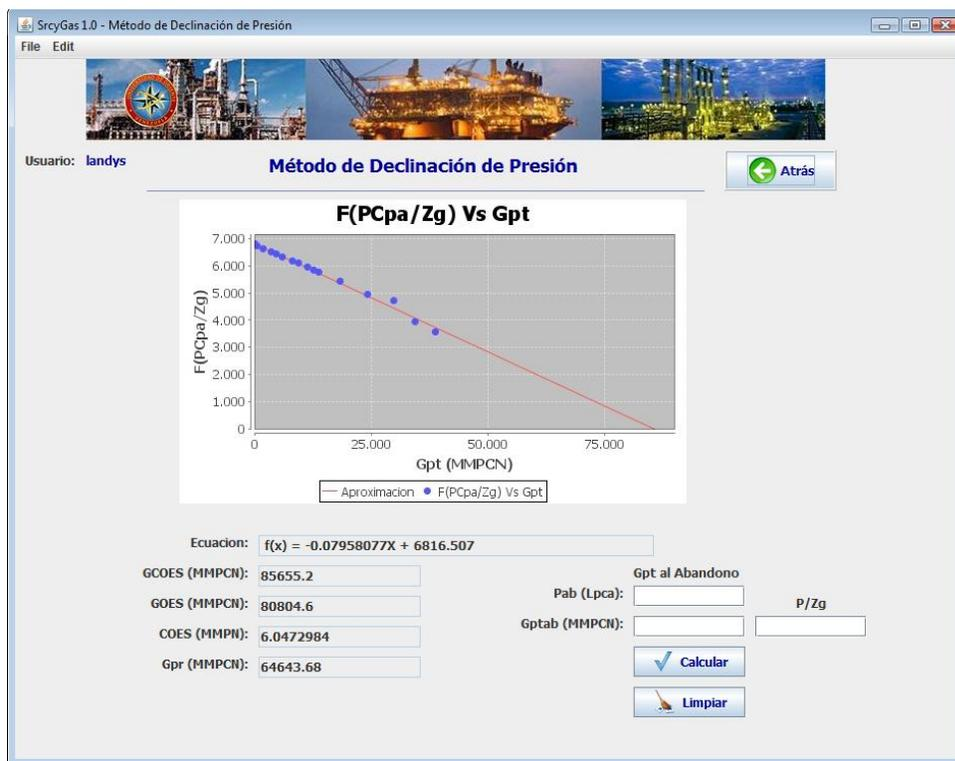
**Figura 4.8.** Variación PCpa/Zgc para un Yacimiento Volumétrico de Gas Condensado de la Aplicación SryGas 1.0. [5]
