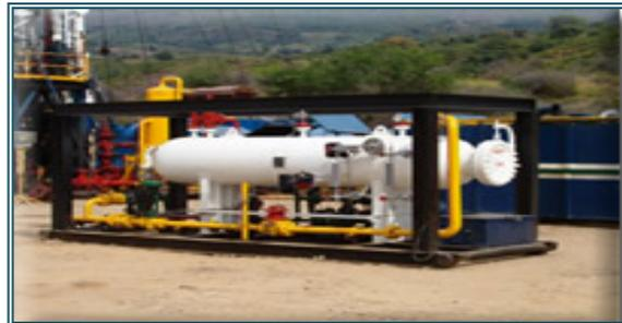
**Figura 2.9** Separador de Prueba.
