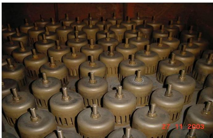
Figura 3. Bandejas con casquetes de burbujeo usadas en un sdgc.
