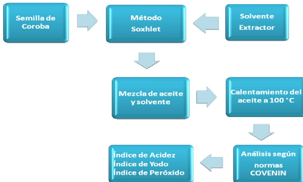
**Figura 3.1 Esquema para la extracción y análisis de los aceites.**
