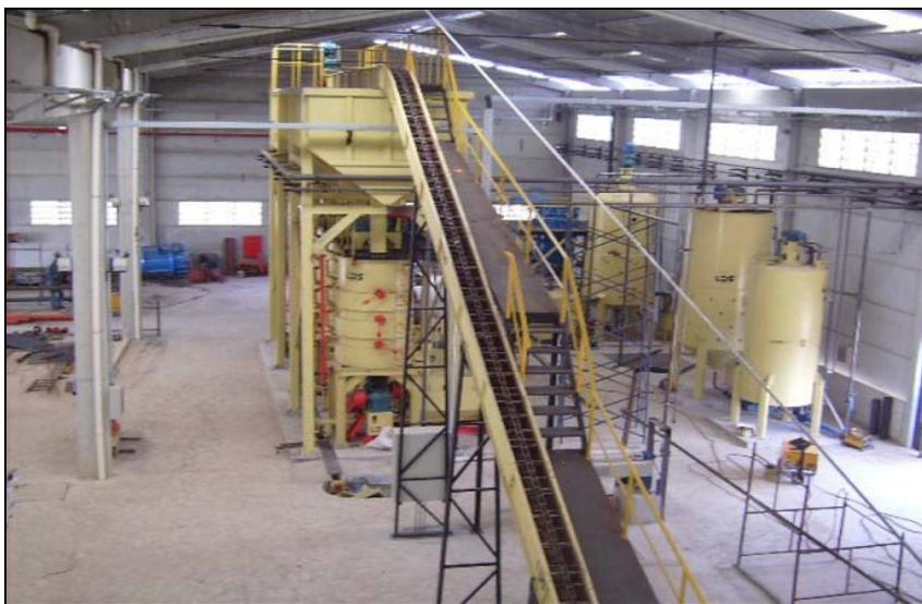
**Figura 2.16** Planta de extracción de aceites.
