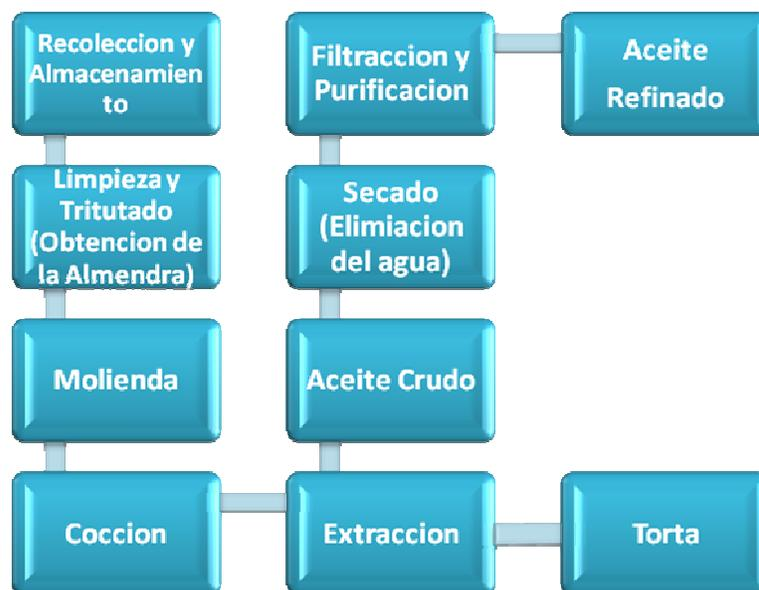
**Figura 2.15 Proceso de extracción artesanal del aceite de semilla de coroba**
