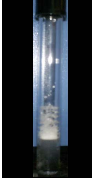
Figura 3.1 Espuma formada en la celda de medición del Turbiscan.
