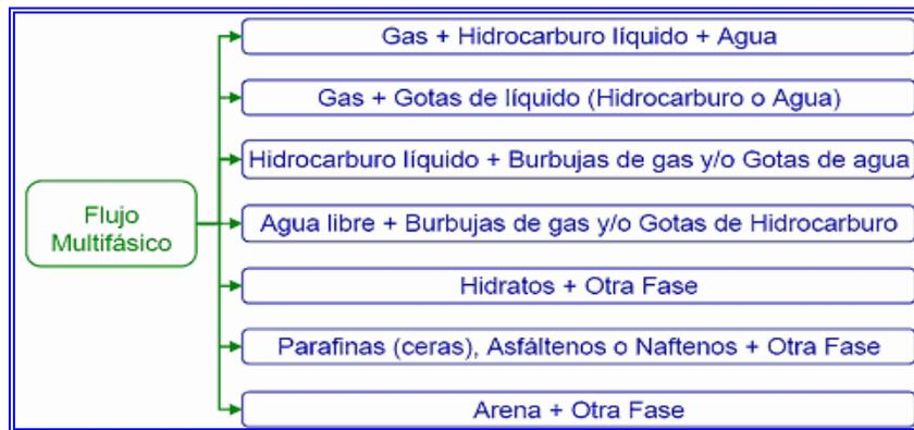
**Figura 2.7. Flujos multifásicos en la producción de hidrocarburos.**
