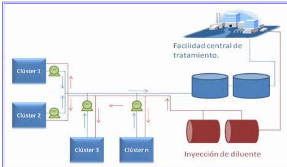
**Figura 2.4. Proceso de extracción con bombeo multifásico.**
