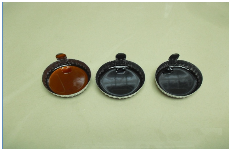
Figura 4.1 Resinas DP1 (A), DP2 (B) y DP3 (C), obtenidas mediante el proceso estándar de síntesis de Lipesa S.A.
