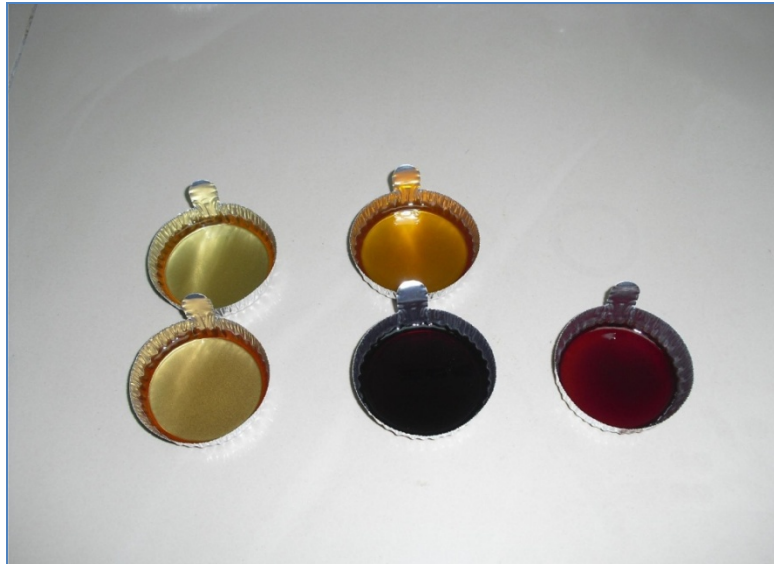
Figura 4.2 Resinas obtenidas con el nuevo proceso: novolaca (A), resol (B) TBF (C).
