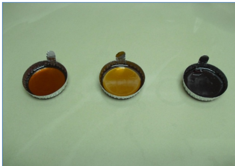
Figura 4.3 Resinas fenólicas etoxiladas: DE1(A), DE2 (B) y DE3 (C).
