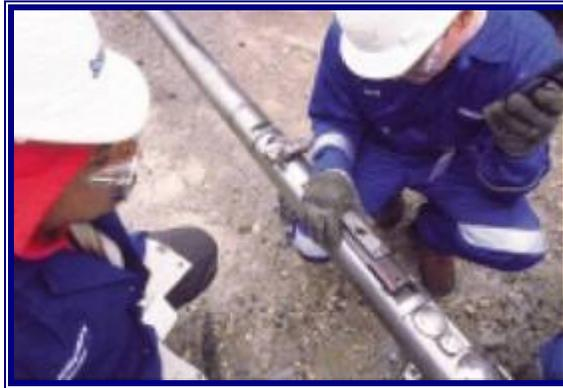
**Figura 2.15 Herramienta de Prueba de Formación CHDT (Oilfield Review 2003/2004)**
