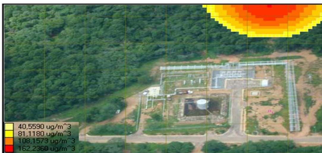
Figura 4.16 Mapa de concentraciones de COV generados por la fosa asociada a la estación de flujo SREF-5
