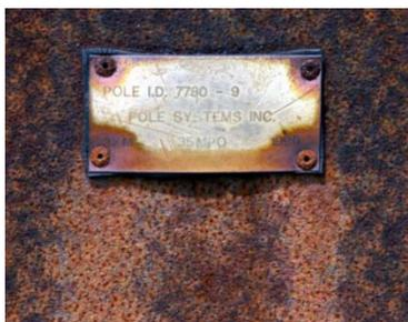
Figura 2.2. Corrosión galvánica, entre dos placas metálicas diferentes.
