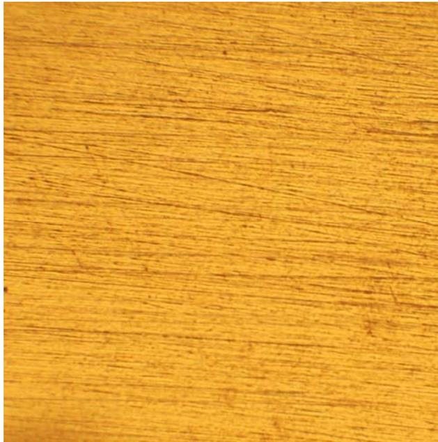
Figura 4.14. Mezcla 20% LCM – kerosene después del ensayo electroquímico, magnificación 150X.
