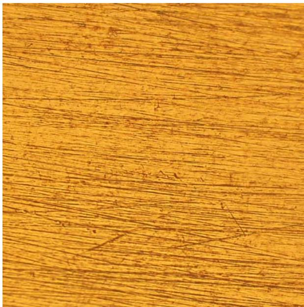
Figura 4.15. Mezcla 20% LCM – kerosene después del ensayo electroquímico, magnificación 300X.
