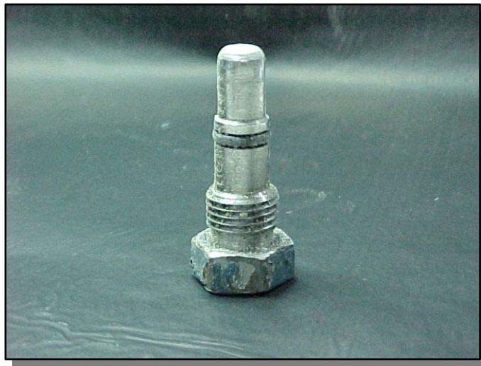
Figura 3.4.- Pieza del regulador contaminada con sólido amarillo - RP Caico
