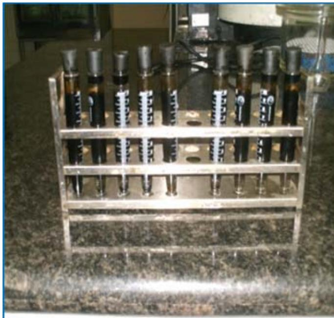
**Figura 3.10 Prueba de botella para la ruptura de la emulsión.**
