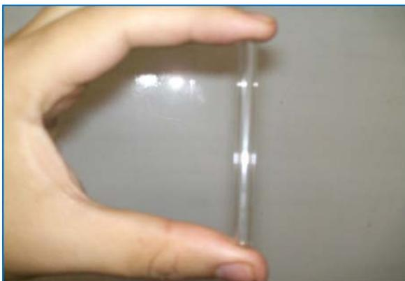
**Figura 3.1 Capilar utilizado para simular la emulsión.**
