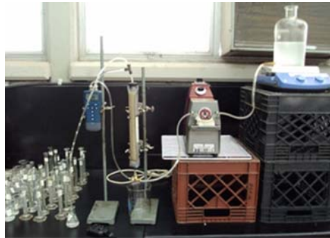
Figura 4.19 Montaje experimental para el estudio del tratamiento de aguas aceitosas en lecho fijo de partículas hidrofobadas.
