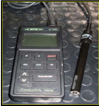
Figura 3.3 Equipo para la medición de conductividad.
