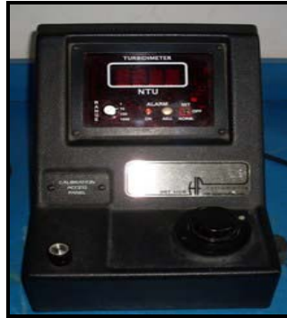
Figura 3.4 Equipo para medición de turbidez.
