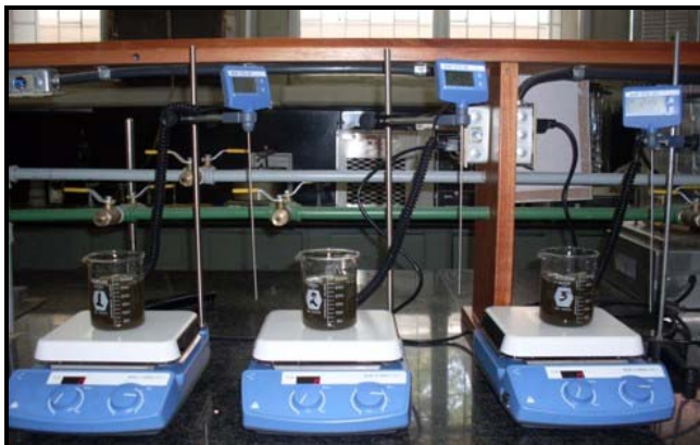
Figura 3.9 Montaje experimental para la prueba de jarra.
