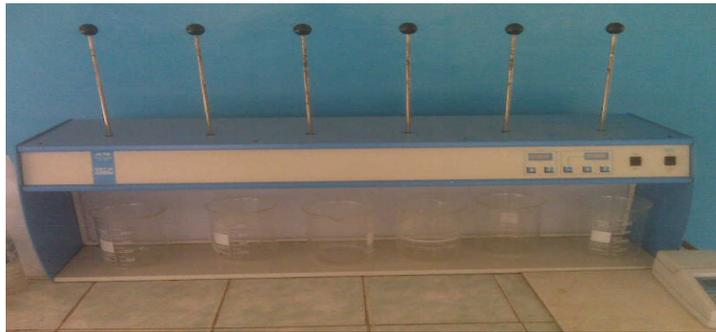
**Figura 2.2** Equipo de prueba de jarra
