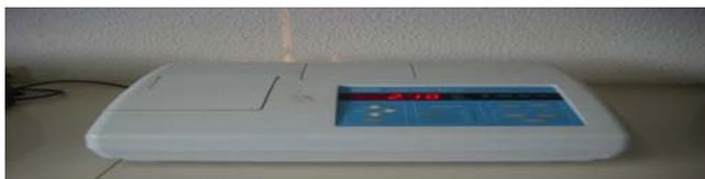
**Figura 3.2 Equipo de medición de turbiedad**
