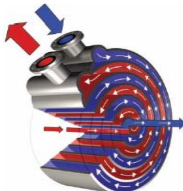
**Figura 2.5. Intercambiador de calor tipo Espiral.** (Alfa Laval, 2010).
