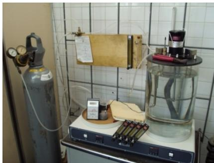
Figura 0.5 **Sistema experimental para el estudio de la espumabilidad y estabilidad de mezclas no acuosas.**
