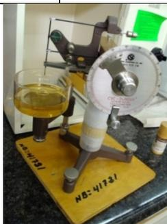
Figura 0.10 **Tensiómetro de Anillo, Du Nouy.**
