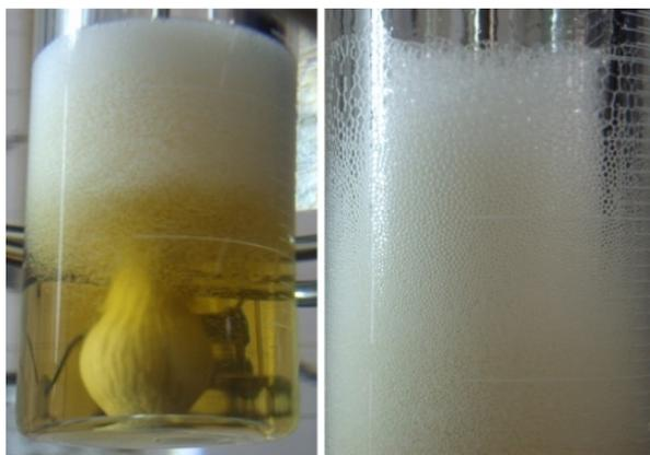
Figura 0.4 **Espuma en formación con caudal de 0,85 l/min y la mezcla 30:70 aceite SAE 50-kerosene con burbujas de tamaño homogéneo.**
