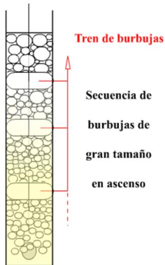
Figura 0.3 **Diagrama de un tren de burbujas.**
