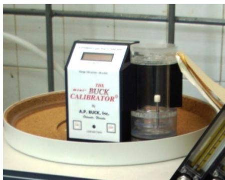
Figura 0.2 Medidor de flujo digital, Mini-Buck Calibrator.
