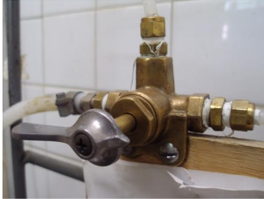
Figura 0.3 **Válvula de alivio del sistema experimental.**
