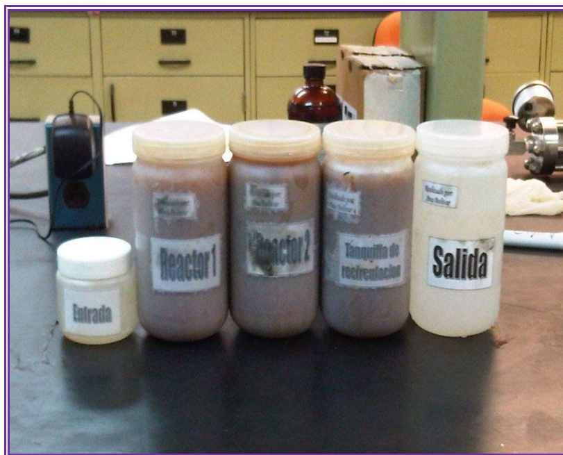
Figura 3.2 Muestras tomadas en diferentes puntos de la planta (Planta de extracción San Joaquín, 1996)
