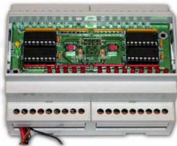
Figura 3.19 Imagen de la unidad de transmisión remota Datasite.
