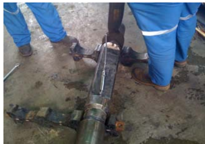
Figura 3.5 Válvula recuperada del pozo SBC-18E acoplada al mandril de inyección para el comienzo de la prueba.
