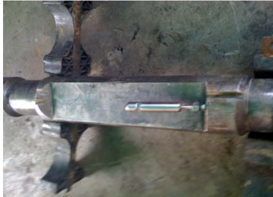
Figura 3.4 Mandril de inyección acoplado con la válvula nueva sometida a 5.000 psi, vista desde cerca.
