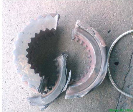
Figura 4.22. Fragmentos del elemento flexible del acople entre el compresor y el motor Atlas Copco GA-75
