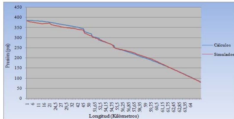
Figura 4.9 Perfiles de presión para el lateral de 24”.
