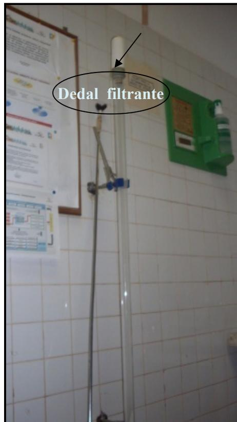
**Figura 3.8.A.** Equipo utilizado para el índice de atrición; mostrando el dedal filtrante y el tubo de vidrio.
