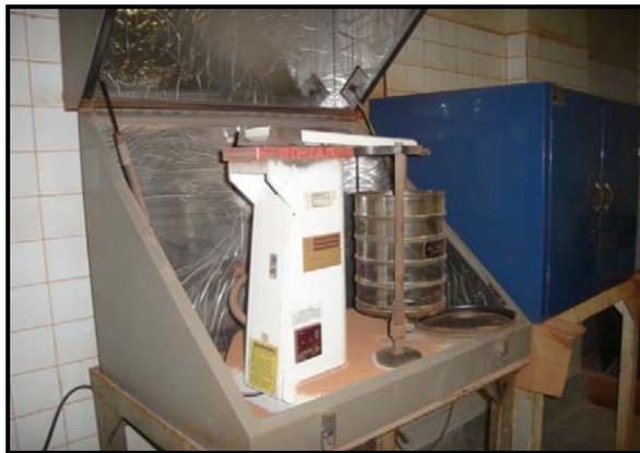
**Figura 3.2.** Equipo *Ro-tap* utilizado para el análisis de distribución granulométrica
