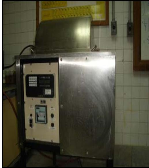
**Figura 3.5.B.** Equipo *Intronics*; mostrando el panel electrónico donde se modifica la temperatura del baño
