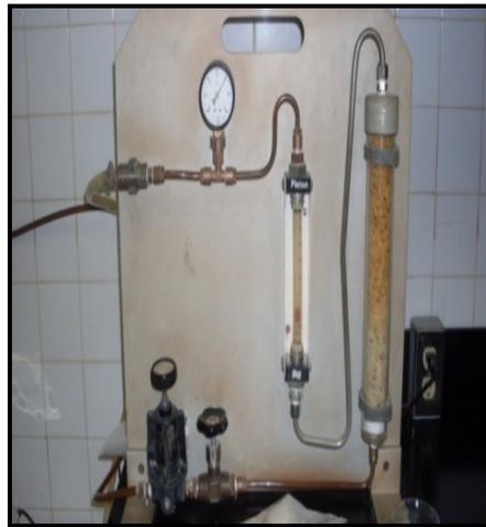
**Figura 3.8.C.** Equipo utilizado para el índice de atrición; mostrando el manómetro.
