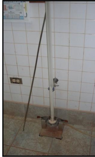
**Figura 3.8.B.** Equipo utilizado para el índice de atrición; con plato de soporte.
