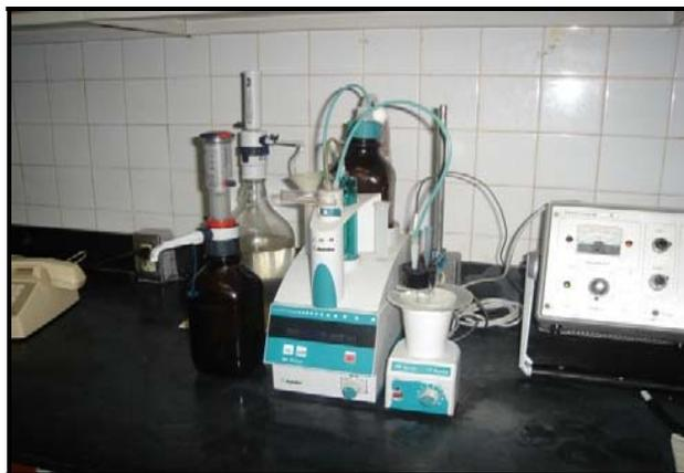
**Figura 3.1.** Equipo utilizado para el análisis de termotitulación
