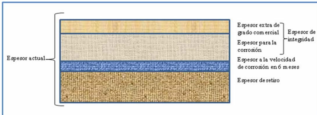
**Figura 2.30. Niveles de espesores de las aleaciones usadas industrialmente [13].**
