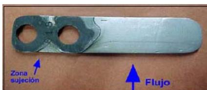
Figura 2.29. Cupón de Corrosión [4].
