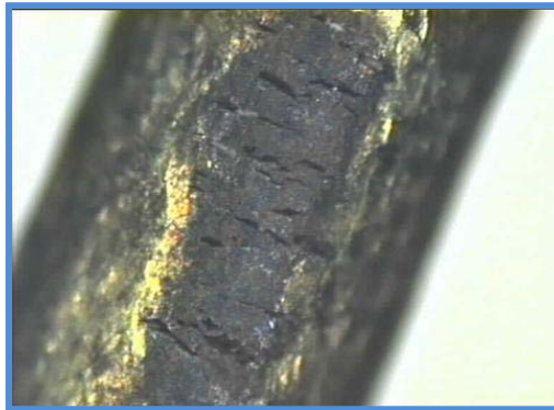
Figura 2.26 Corrosión Bajo Tensiones [1]
