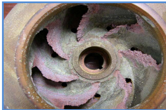
Figura 2.35 Corrosión por erosión en una bomba de agua
