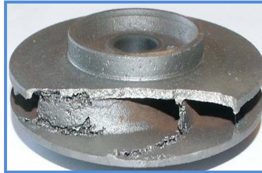
Figura 2.38 Corrosión-Erosión por cavitación en un rodete de bomba centrífuga [11]
