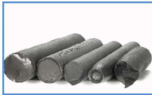
Figura 2.27 Corrosión por Fatiga
