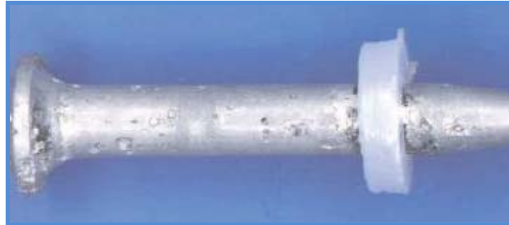
Figura 2.24 Corrosión Alveolar o Pitting [9]
