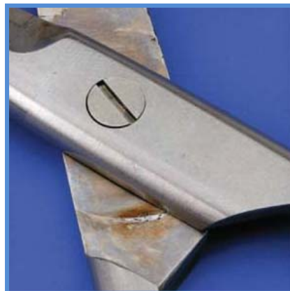
Figura 2.39 Corrosión por Desgaste (en una tijera)
