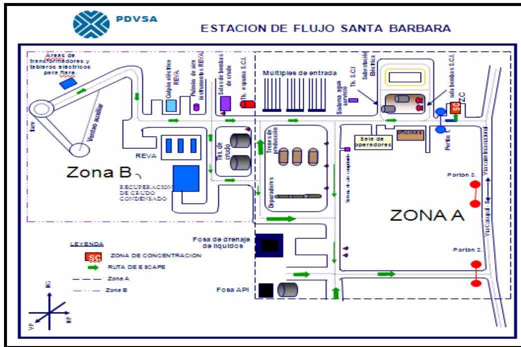
Figura 2.1 Esquema de la estación de flujo Santa Bárbara. [4]
