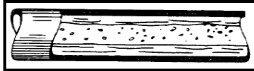
Figura 2.11 Patrón de flujo tipo anular. [9]
