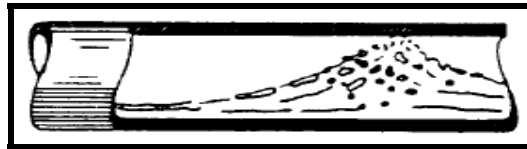
Figura 2.10 Patrón de flujo intermitente tipo tapón. [9]
