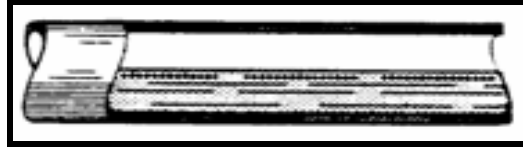
Figura 2.8 Patrón de flujo tipo estratificado suave. [9]
