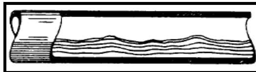
Figura 2.9 Patrón de flujo tipo estratificado ondulante. [9]
