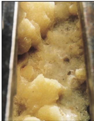
**Figura 2.10.** Incrustación de Carbonato de Calcio <sup>[11]</sup>
