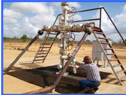
**Figura 3.5.** Toma de muestra de agua a pozo de doble sarta
