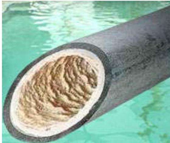
Figura 2.3 Corte transversal de un caño de agua que muestra claramente el efecto dañino del pasaje de altos niveles de minerales.
