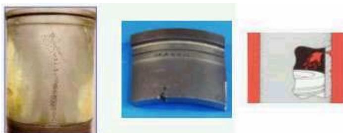
Figura 2.8 Corrosión en las camisas del motor
