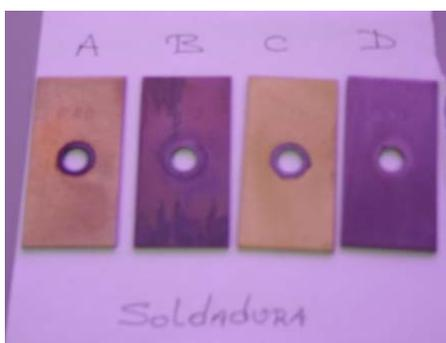
**Figura 4.7 Aspecto de las láminas de soldadura al final de la prueba de corrosividad**
