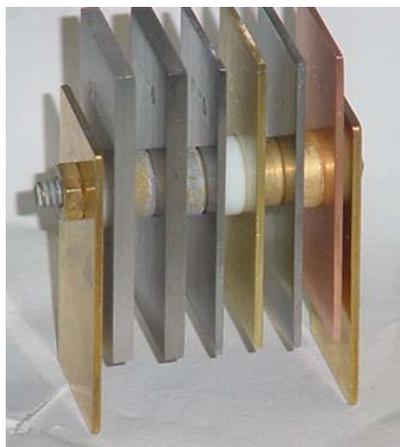
**Figura 3.6 Arreglo de los cupones de corrosión**
