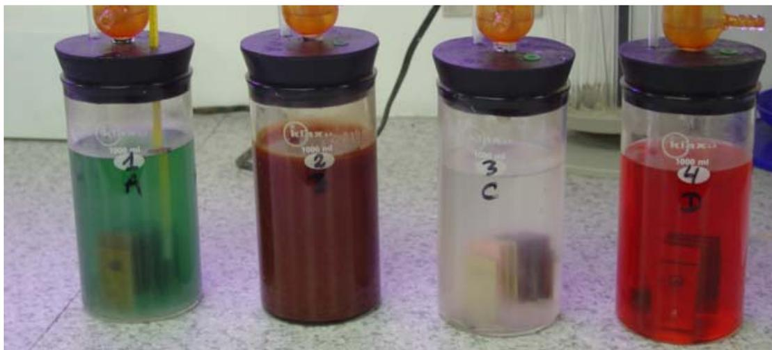
**Figura 4.4 Aspecto de los refrigerantes al final de la prueba de corrosividad**
