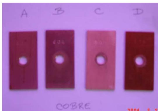
**Figura 4.5 Aspecto de las láminas de cobre al final de la prueba de corrosividad**
