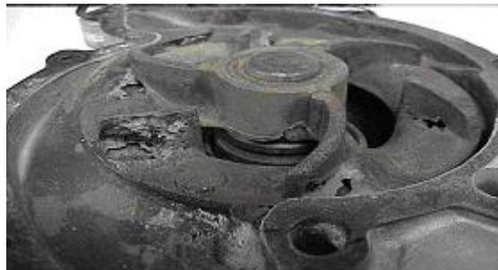
Figura 2.7 Corrosión por picadura de bomba expuesta a cavitación
