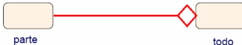
**Figura 2.12.** Representación de una Relación de Agregación entre Dos Clases.
