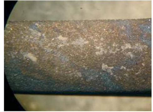
Vistas de diferentes zonas de la prótesis femoral al momento de la extracción in situ. Se observa un proceso de corrosión generalizado sobre la superficie
