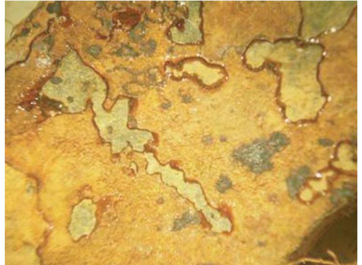
Aspecto superficial de las muestras sumergidas en las aguas de las estaciones. A la izquierda, limo, nichos de bacterias y cristales de sales depositadas en la superficie metálica, y a la derecha, nichos de bacterias y zonas con pérdida metálica. Observación mediante estereoscopio. Mag. 15 X.
