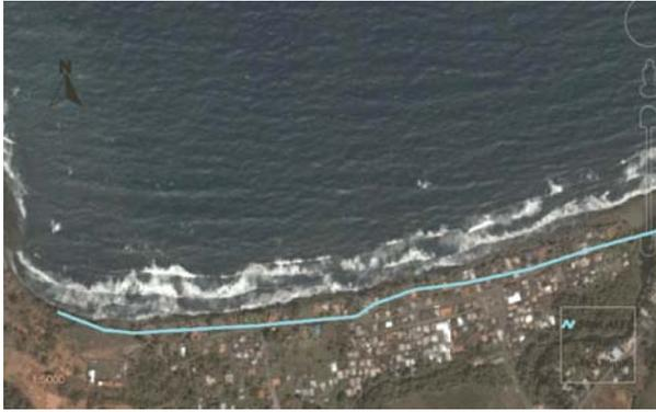
Fig. 4. Vista esquemática del nivel de erosión (línea) que puede esperarse en María Chiquita en el año 2100, utilizando el escenario SRES A1F1. Imagen base obtenida con Google Earth.
