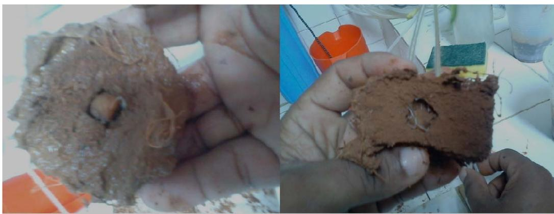
Figura 51. Fotos del hidrogel semi-IPN de PAAm/PHB 90/10 sintetizado por microondas luego de haber estado incubado en el suelo durante 30 días.
