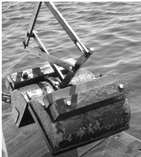
Figura 2. Dragas tipo Pertesen para el muestreo de sedimentos superficiales.
