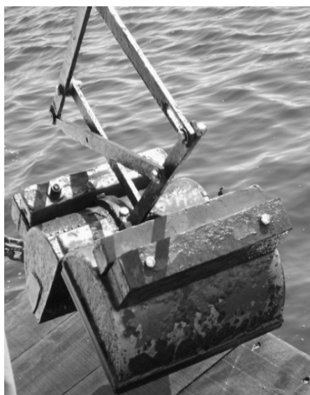
Figura 2. Draga tipo Petersen para el muestreo de sedimentos superficiales.
