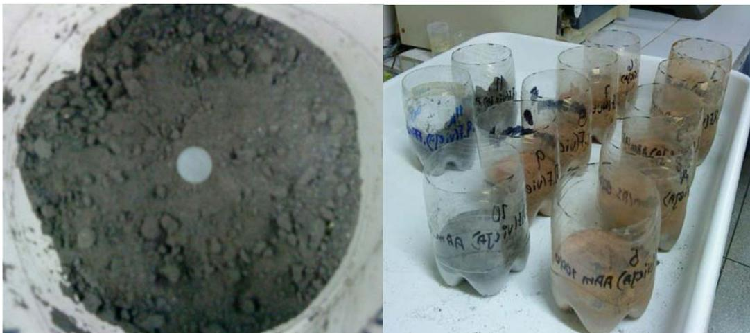
Figura 4. Fotografía del montaje experimental para la incubación de las pastillas xerogel en la mezcla suelo ácido/roca fosfórica.
