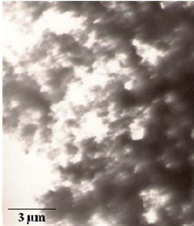
Figura 23. Micrografía electrónica de transmisión de la ZSM-5 con relación Si/Al = 20
