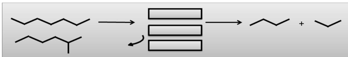
Figura 2. Impedimento de moléculas de sustrato para alcanzar sitios ácidos de la zeolita.
