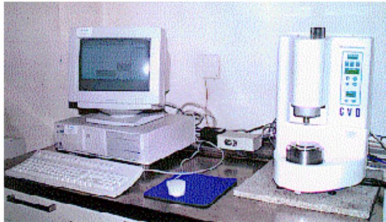
Figura 20. Equipo de reómetro de corte dinámico (DSR).
