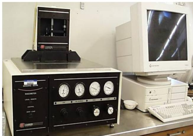
Figura 18. Reómetro de flexión (BBR).
