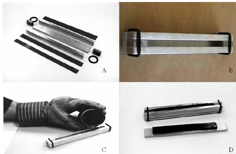
Figura 19. Láminas de aluminio para el molde (A), molde armado y listo para colocar la mezcla asfáltica de aluminio (B), molde listo para sumergir en el baño a  $-12^{\circ}\text{C}$  (C) y mezcla asfáltica lista para el análisis (D).
