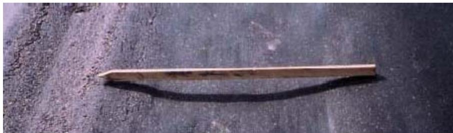
Figura 4. Deformación permanente.
