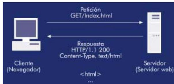
Figura 1. Funcionamiento del protocolo HTTP.
