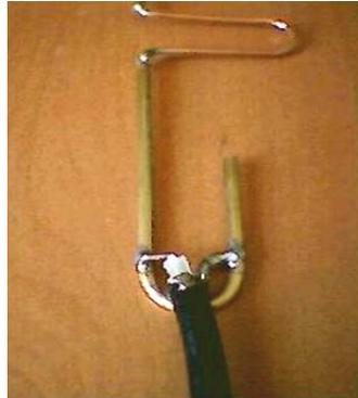
Figura 16. Extremo final de una antena omni-jota.
