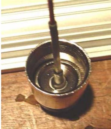
Figura B3. Conector N-Hembra rearmado y con trozos de goma de borrar sujetando el alambre de cobre y la pin central soldados.
