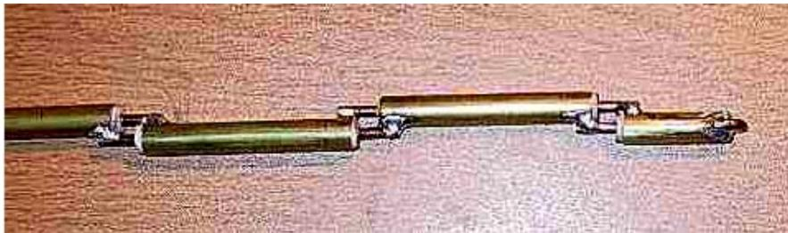
Figura 13. Ejemplo de antena coaxial después de terminar las soldaduras.
