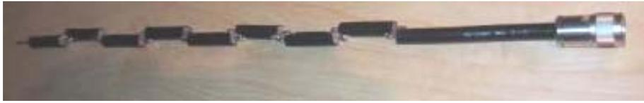
Figura 14. Antena coaxial de ocho segmentos (elementos).
