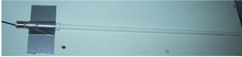
Figura 11. Antena colineal con cobertura de tubo PVC.
