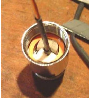
Figura B4. Conector N-Hembra rearmado, aspecto final
