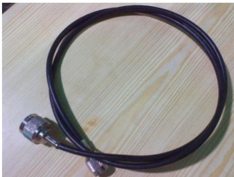
Figura 36. *Pigtail* con conectores N-Macho y RP-TNC macho.
