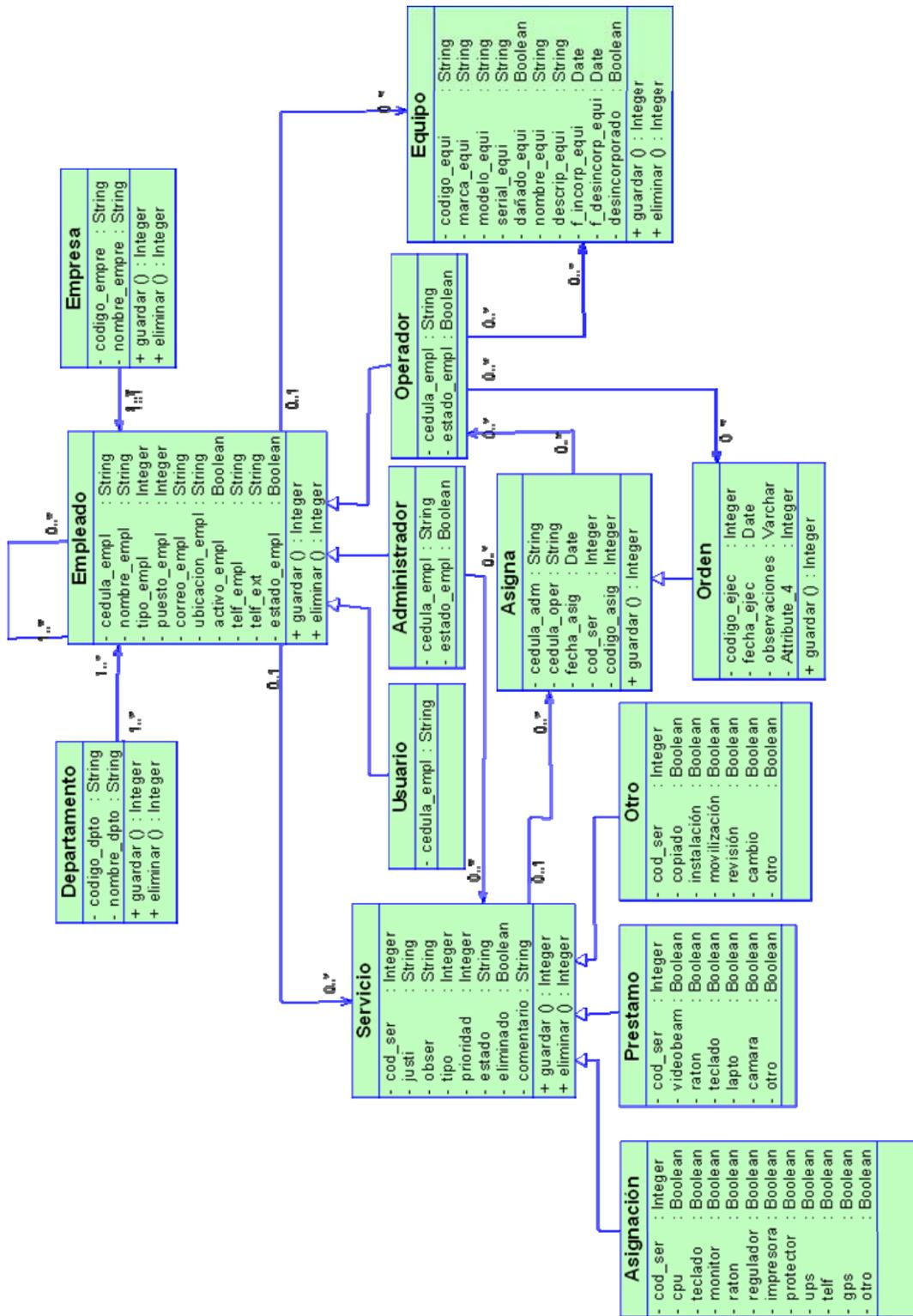
Figura 1. Diagrama de clases del Sistema de Control de Requerimientos Informáticos (SCRJ).
