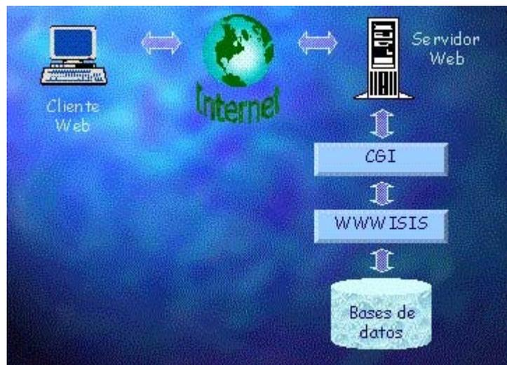
Figura 1. Esquema de una estructura cliente servidor.
