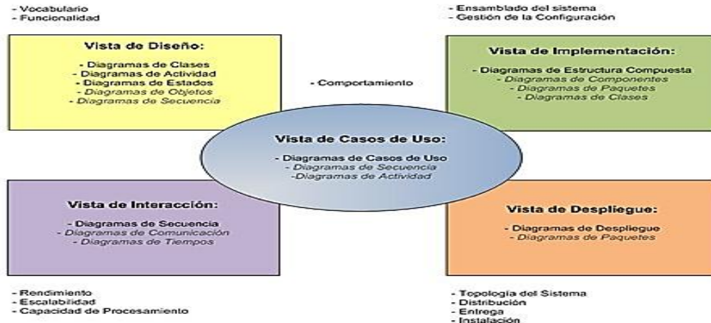
Figura 8. Arquitectura de un Sistema de Software (UML 2.0)
